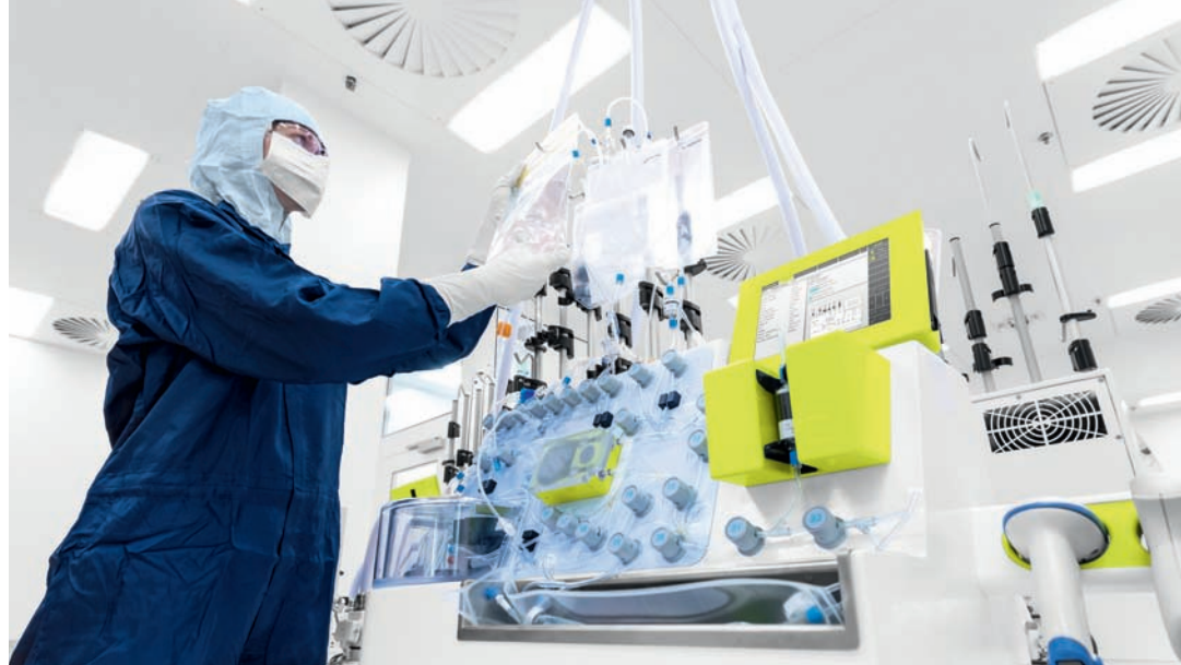
Clinimacs Prodigy All-in-one System zur Zellprozessierung nach GMP © Miltenyi Biotec
